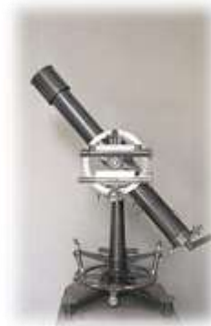
Il telescopio zenitale fatto realizzare nel 1890 a Londra, su richiesta di Vincenzo Cerulli, dalla ditta Troughton & Simms
